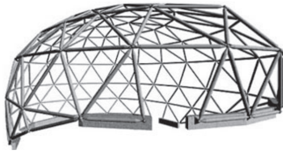
FIGURE 5.1 – Exemple de structure treillis
