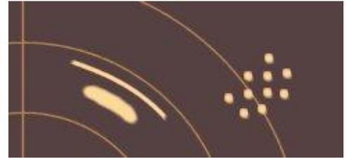
Figure 30: Un écho non ambigu (avec une réponse IFF) et un IFF «ambiguë» obtenus avec une PRI variable.
