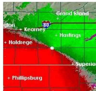
Figure 23: Affichage Doppler pour un radar météorologique : rouge pour la composante s'éloignant et vert pour celle s'approchant.
