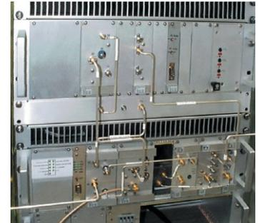
Figure 11 : Récepteur et générateur de signaux d'un radar ASR-E de contrôle aérien (Fabricant : EADS)
