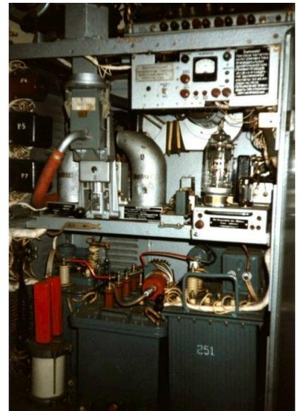
Figure 6: Transmetteur à oscillateur de puissance d'un radar russe P-37 (code OTAN «Bar Lock»)
