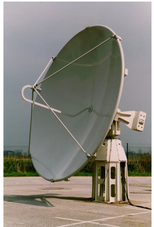
Figure 1 : Antenne parabolique du radar météorologique METEOR 360
