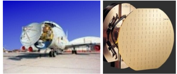
Figure 17 : Antenne parabolique à gauche et antenne réseau à commande de phase à semi-conducteurs Collins à droite
