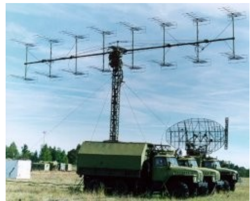
Figure 11: Radar utilisant un groupe d'antennes Yagi-Uda, (P-18 «Spoon Rest D») avec gain G = 69
