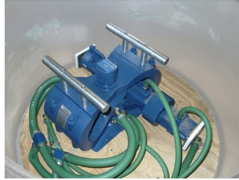
Figure 17 : Amplificateur à champs croisés L-4756A refroidi à l'eau dans son étui de transport.
