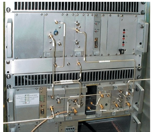
Figure 1 : Récepteur et générateur de signaux d'un radar ASR-E de contrôle aérien (Fabricant : EADS)
