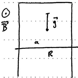
Un circuit vertical est plongé dans un champ magnétique. Ce circuit est fermé par un barreau en chute libre au contact des rails verticaux. La résistance totale vaut  $R$ .
