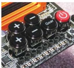
L'OC Touch est conçu pour simplifier la vie des bidouilleurs. Sur les modèles d'entrée de gamme, il se limite à un bouton "Power" bien visible qui permet de démarrer la carte mère de manière plus propre qu'avec un coup de tournevis hasardeux. Sur les cartes plus évoluées, on y trouve plusieurs autres boutons permettant de modifier d'une seule pression le ratio du CPU ou le BCLK, de faire un Clear CMOS ou encore
