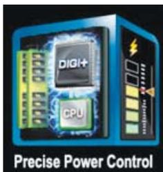
Pour expliquer le DIGI+, il faut reprendre quelques bases. La carte mère intègre un étage d'alimentation (VRM) qui convertit le +12V de l'alimentation en une faible tension (1-2 volts) que va utiliser le processeur. Ce VRM utilise un schéma à découpage classique avec MOSFET, inductances et condensateurs. Autrefois, les paramètres du découpage
