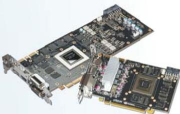
La GeForce GTX 780 utilise un PCB "long" de Titan alors que la GTX 760 se contente d'un PCB court et peu coûteux.
