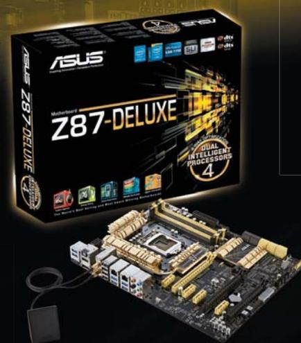
**Caractéristiques :** Socket LGA1150 pour la 4<sup>ème</sup> Génération de processeurs Intel Core i7/i5/i3, Pentium/Celeron, Chipset Intel® Z87, 4 x DIMM, max. 32 Go, DDR3 2800(O.C.), 8 x USB 3.0 (2 en façade)
