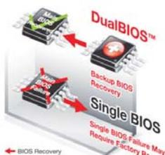
Le DualBIOS a constitué une petite révolution lors de sa sortie et demeure largement promu par Gigabyte. Il s'agit en fait d'une deuxième puce de mémoire Flash qui peut se substituer à la première en cas de problème avec le BIOS. Un petit interrupteur permet de sélectionner le BIOS à utiliser lors du démarrage. Tout cela est bien beau, mais voilà : l'innovation s'est un peu évanouie avec le temps puisque le DualBIOS a été annoncé à l'origine sur la
