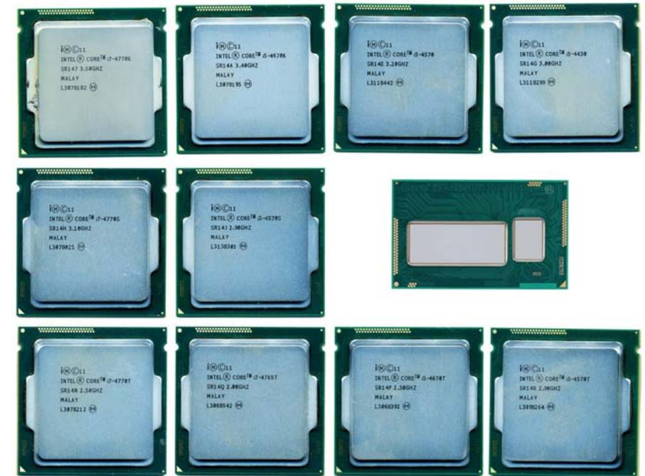
La gamme presque au complet avec les CPU "S" et "T". Au centre, un Core i7 "U" destiné aux ultraportables.
