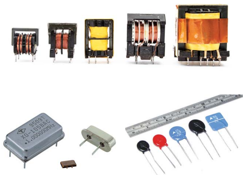
En haut, une série de 5 transformateurs ; à gauche, trois oscillateurs ; et à droite sous la règle, 5 variateurs.
