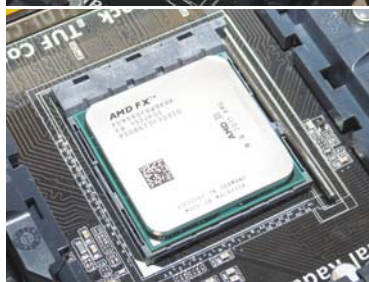
Le FX-9590 fonctionne sur un socket AM3+ mais uniquement avec une carte mère capable de délivrer 250 W.
