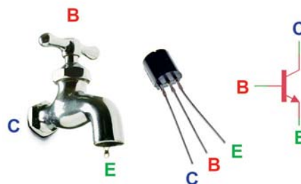
Le courant, commandé par la base (B), circule entre l'émetteur (E) et le collecteur (C).
