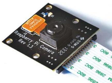
Un module webcam qui se connecte sur le port CSI.
