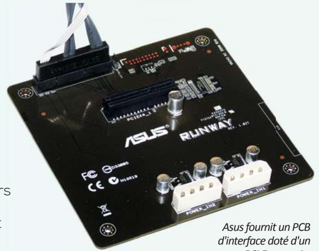
Asus fournit un PCB d'interface doté d'un connecteur PCI Express 4x.
