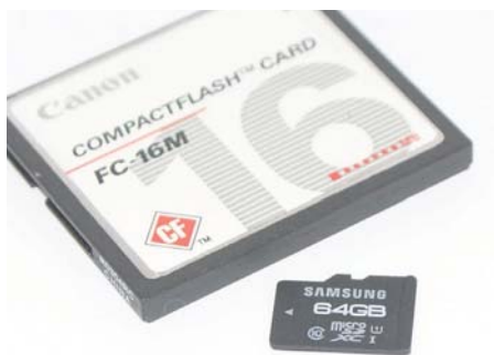
Onze ans séparent ces deux cartes. La plus grande (CompactFlash) a une capacité de 16 Mo, la plus petite (microSD) une capacité de 64 Go, soit 4 000 fois plus.
