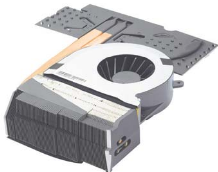
Avec un GPU consommant plus de 75 W, le ventirad intégré peut s'avérer massif et bruyant.
