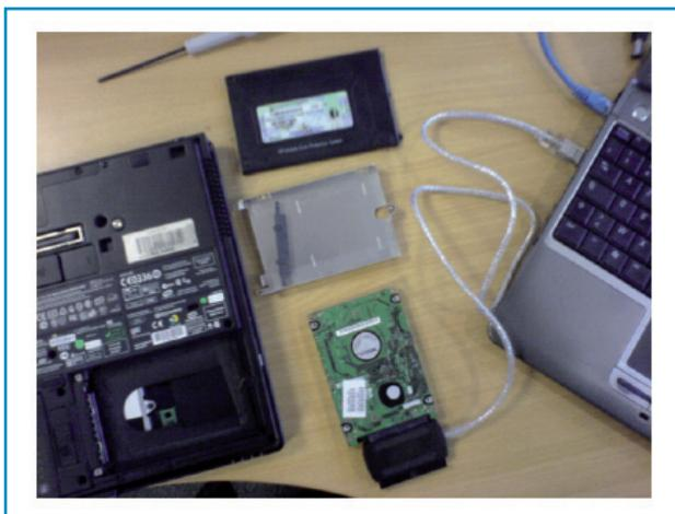
1 Accès au disque d'un portable avec un adaptateur IDE-USB
