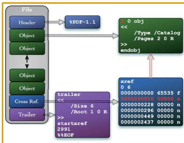
Figure 1 - Structure physique d'un fichier PDF
