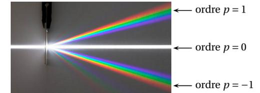
L'angle de déviation de l'ordre  $p$ , pour la longueur d'onde  $\lambda_0$ , est  $D = |\theta_p - \theta_1|$ . Lorsque  $\theta_1$  varie,  $D$  passe par un minimum pour  $\theta_p = -\theta_1$  ; le plan du réseau est alors bissecteur des rayons incident et diffracté. Le **minimum de déviation**  $D_m$  de l'ordre  $p$  pour la longueur d'onde  $\lambda_0$  vérifie
