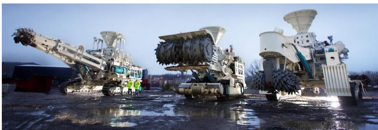
Figure 8 - Équipements pour l'exploitation sous-marine d'amas sulfurés (Nautilus Minerals, 2016)
