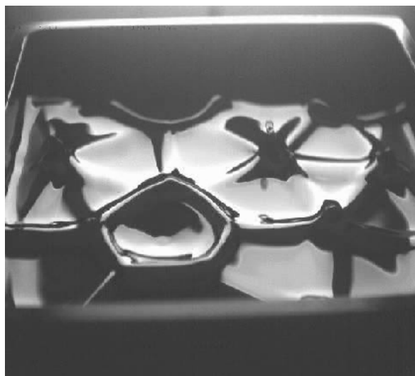
FIGURE 5.15 – Pour des paramètres expérimentaux identiques à ceux nous ayant permis d’obtenir le motif représenté sur la figure (5.8), le motif est indépendant de la forme de la cellule. Ici, les expériences sont réalisées dans une cuve carrée de 17 cm de côté.
