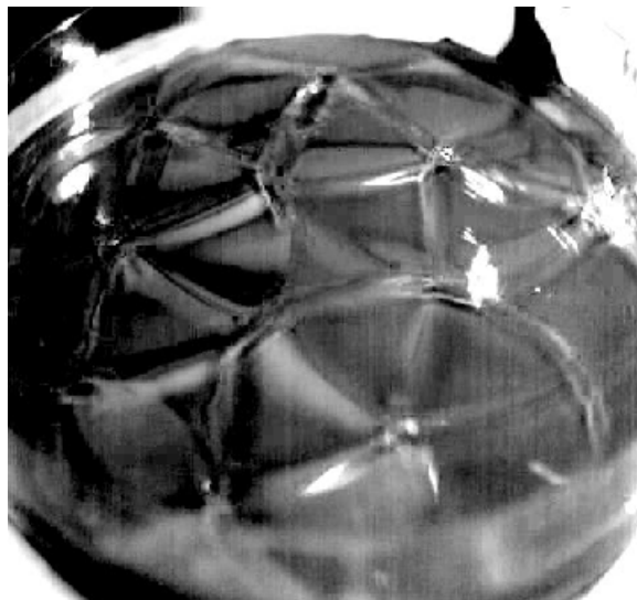
FIGURE 5.12 – Pour les mêmes paramètres expérimentaux que ceux utilisés pour la cellule précédente, le motif est indépendant de la taille de la cellule. Ici, les expériences sont réalisées dans une cuve cylindrique de 17 cm de diamètre.
