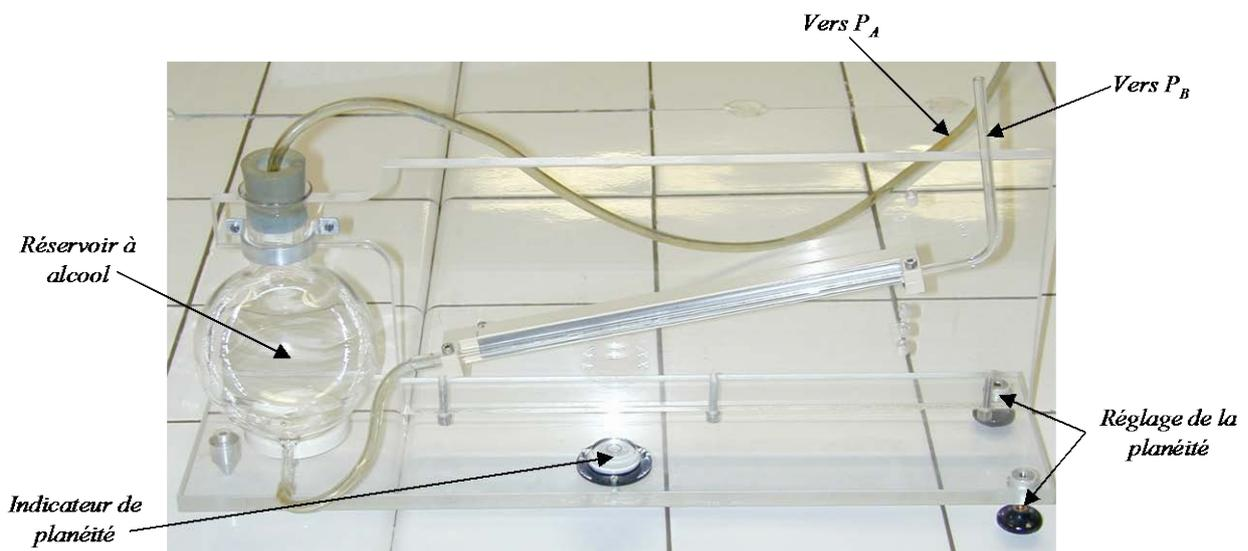
Figure 4.4 : Manomètre à tube incliné utilisé
