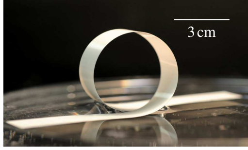
FIGURE 2.5 – Boucle formée avec une languette de feuille de polymère posée sur de l'eau (partiellement mouillante). La boucle a une forme de cercle de rayon R = L_{EC}/\sqrt{2(1 + \cos \theta)} , où \theta est l'angle de contact du liquide sur la languette.
